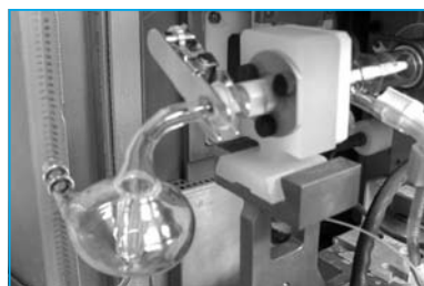
具有12/5球形接头的 SCP SCIENCE PEEK 塑料炬管 支架可以与具有12/5插槽的雾化 室想连接。
