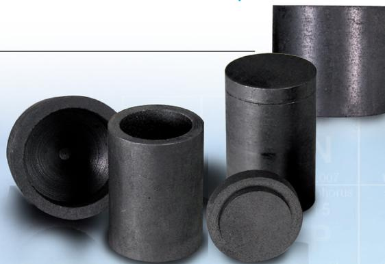
Les creusets de fusion en graphite SCP SCIENCE sont une alternative économique aux creusets en platine/en or et en zirconium. Les creusets SCP SCIENCE ne réagissent pas avec les échantillons pendant la fusion car ils sont à la fois chimiquement inertes et résistants à la chaleur. Le faible coût de ces creusets permet leur élimination, éliminant à la fois le besoin de procédures de nettoyage fastidieuses et éliminant la possibilité de contamination croisée des échantillons.
