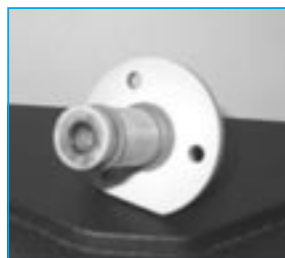
Dégradation UV du PEEK
